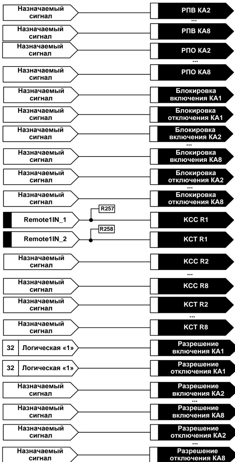
Рисунок 34 – Конфигурируемые входы для дистанционного управления коммутационными аппаратами
